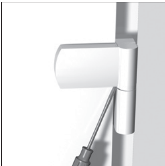
Демонтаж декоративной накладки створочной части петли.
